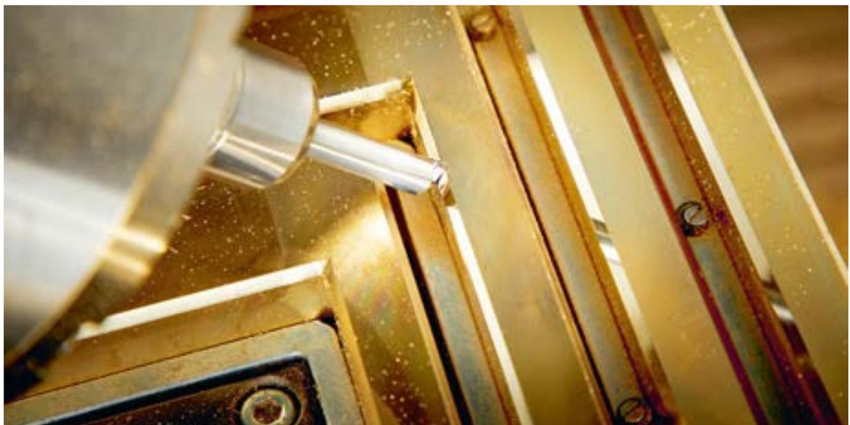
RECHTS: Bis zu fünf Mal wird eine Linie gefräst, die im Gesamtbild zum **Diamantschliff** wird.
